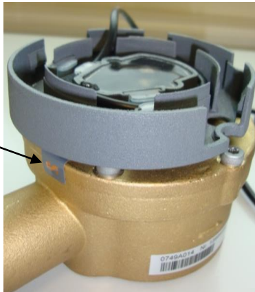
Im Werk angebrachte Plombierungen am Durchflusssensor (1) und am Temperaturfühler (2) des Superstatic 749
